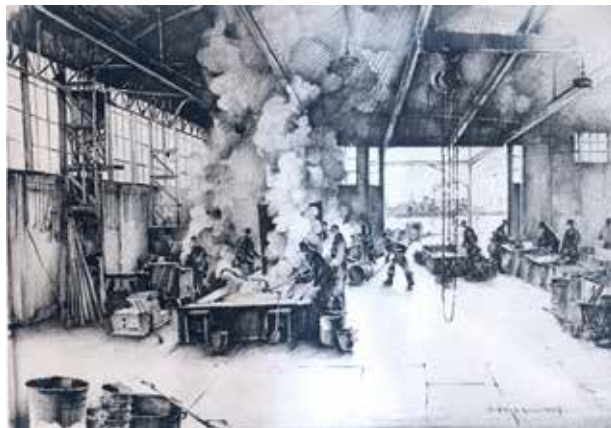
Amsterdam, het interieur van de verzinkerij van Johan Vis, destijds gevestigd bij de scheepswerven, schets van Dirk Kruizinga begin jaren dertig van de twintigste eeuw, archief NedCoat Amsterdam.
