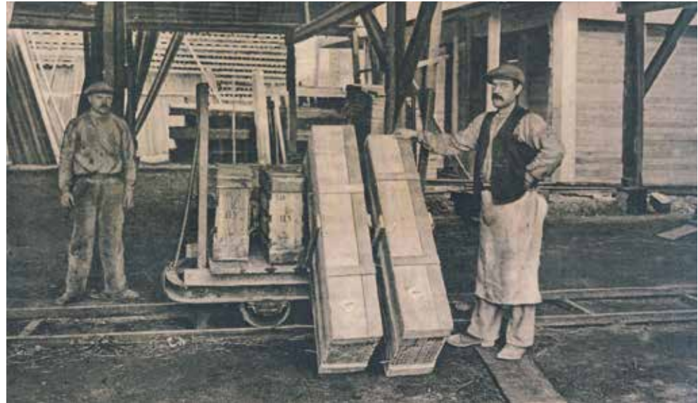
Maassluis, transport van glas in kisten in de Eerste Hollandsche Vensterglasfabriek Maassluis via smalspoor, foto ca. 1910, maker onbekend, Collectie Gemeente Museum Maassluis.
