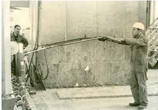
Tiel, het getrokken glas komt omhoog waarna het verder wordt verwerkt, foto jaren zestig van de twintigste eeuw, Historisch Beeldarchief Glaverbel Nederland B.V. (nu: AGC Glass Europe).
