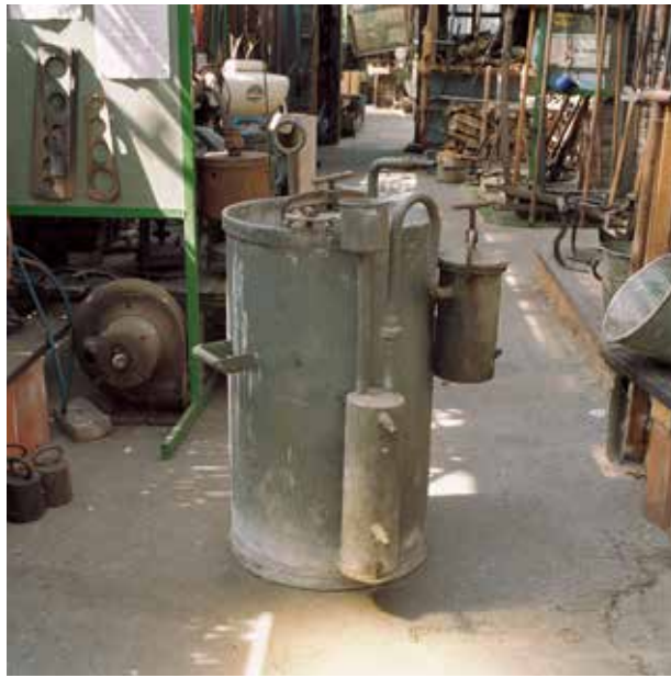
Carbid-lasapparaat voor het lassen van constructies in het Museum Jan Knijnenburg in Hoek van Holland, foto IJ.Th. Heins 2005, no. 513.848 Collectie RCE.
